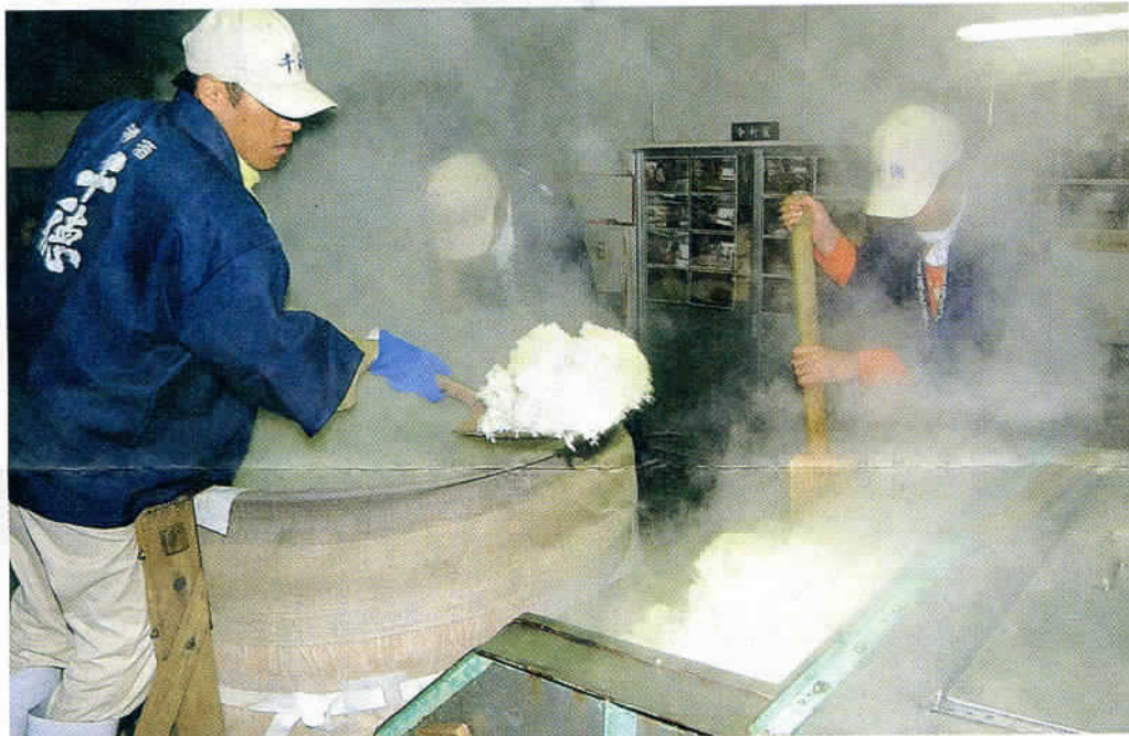
蒸し上がった酒米を放冷機に移す蔵人
